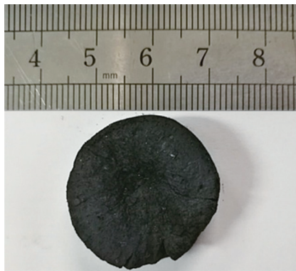
(a) ZnO_{nws}/RGO/PDMS 泡沫复合材料
